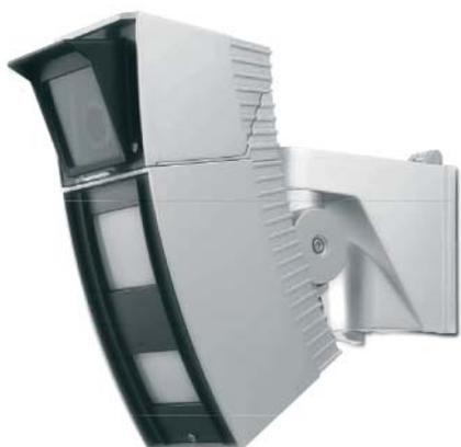
Новая серия Redwatch, совмещает в себе надежный уличный извещатель с площадью детекции 30x20 м и высококачественную видеокамеру. Такая комбинация значительно улучшает эффективность системы безопасности, поскольку отсутствует несоответствие углов обзора камеры и извещателя, которое может возникнуть при раздельной установке устройств.
