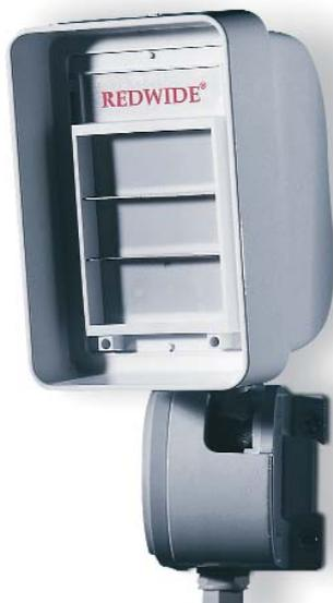
Redwide® – серия широкоугольных пассивных ИК извещателей уличной установки с диапазоном рабочей зоны 50x30 м. Тройной пироэлемент и цифровая схема обработки сигнала обеспечивают надежную работу извещателя в широком диапазоне температур. Запатентованная оптическая система позволяет отсеивать низкочастотные волны, воспринимая излучение только в ИК спектре. Компьютерное моделирование отражающих поверхностей с золотым напылением обеспечивает идеальную фокусировку ИК лучей на пироэлемент извещателя.
