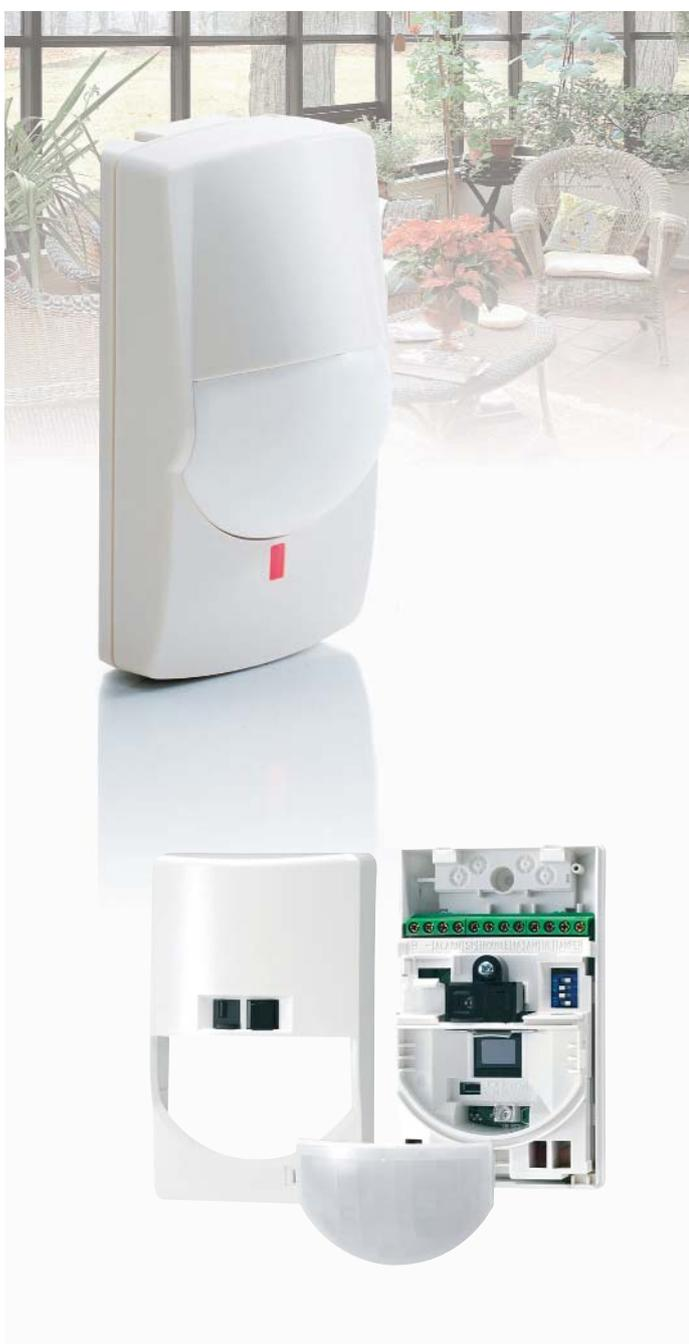
Человеческое тело излучает энергию в ИК диапазоне с длинами волн порядка 10 микрон. Тела с разными температурами излучают энергию с разной интенсивностью. Принцип действия пассивных ИК-извещателей основан на выявлении разницы температур между окружающим фоном и объектом детекции. Современные извещатели способны отличать человека от других источников ИК энергии (птиц, собак, падающих листьев и т.д.)
