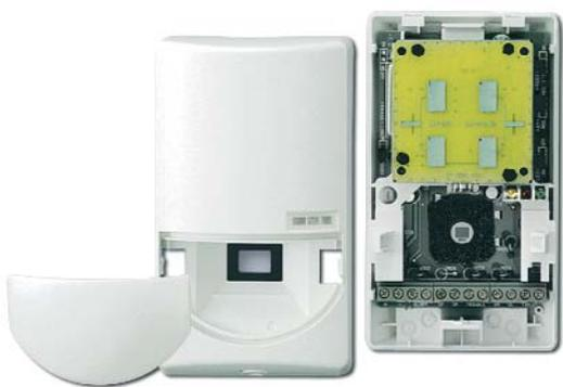
В своей работе комбинированные извещатели используют не один, а два независимых метода детекции: пассивный инфракрасный и микроволновый. Пассивная часть извещателя анализирует разницу температур аккумулированной энергии в ИК диапазоне, тогда как микроволновая часть реагирует на разницу частот переданного и отраженного сигналов.
