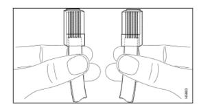
Существует три типа часто используемых кабелей RJ-45. прямой, кроссовый и скрученный. Положите рядом два конца кабеля RJ-45. На конце каждого из них есть восемь разноцветных полосок или контактов. Если порядок следования цветных контактов совпадает на обоих концах, такой кабель называется прямым. Если два конца кабеля имеют противоположный порядок цветов – кабель является скрученным.
