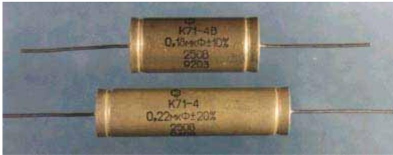
Конденсаторы металлопленочные полистирольные. Уплотненной конструкции в цилиндрических металлических корпусах, однослойные. Имеют стабильные электрические характеристики и высокую надежность. Используются для работы в цепях постоянного, переменного, пульсирующего тока и в импульсных режимах.
