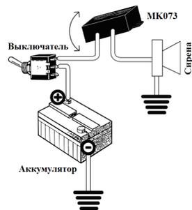
Схема подключения датчика к бортовой сети
