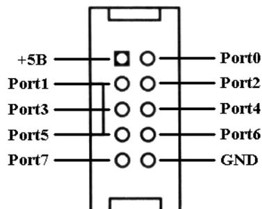
Рис. 3. Схема расположения выводов портов контроллера
