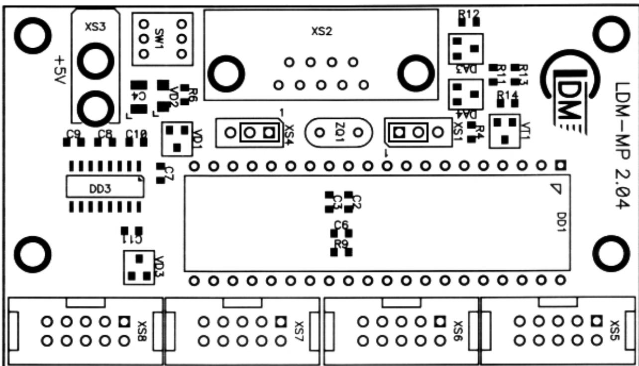
Рис. 4. Внешний вид печатной платы контроллера-конструктора LDM-MP 2.04
