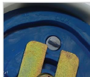
В исполнениях ФРЛ-02 и ФРЛ-03 имеется возможность регулировки порога срабатывания от 5 до 50 лк.
