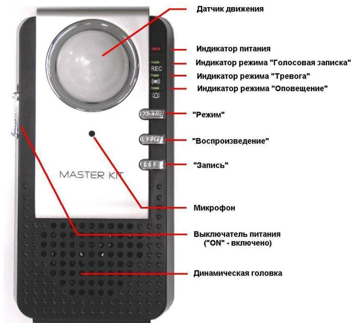
Рис.1 Общий вид устройства и его органы управления
